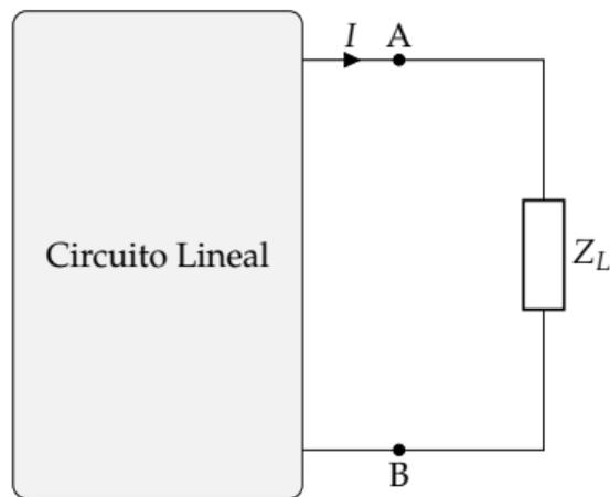
... la impedancia de carga que hay que conectar entre sus terminales AB para obtener la máxima potencia disponible es:
